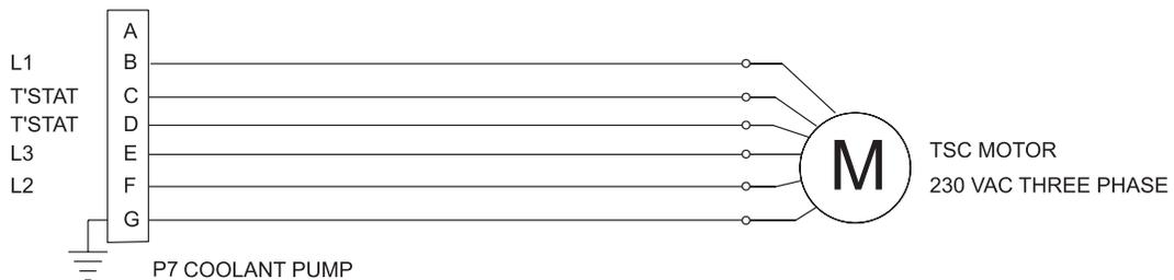
NOTE: CONNECTORS ARE LOCATED ON SIDE OF CONTROL CABINET.
